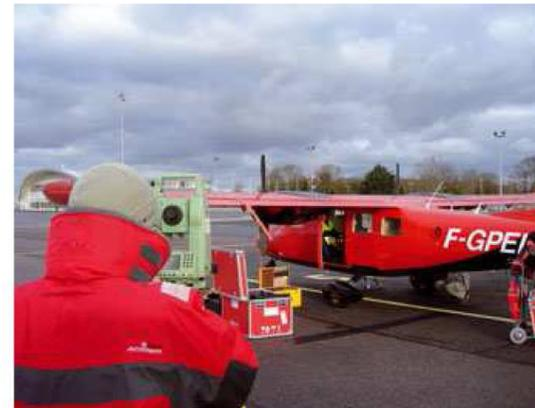
Embarqué dans un avion spécialement équipé, le Lidar permettra de réaliser des relevés topographiques avec une précision de 10 cm.
